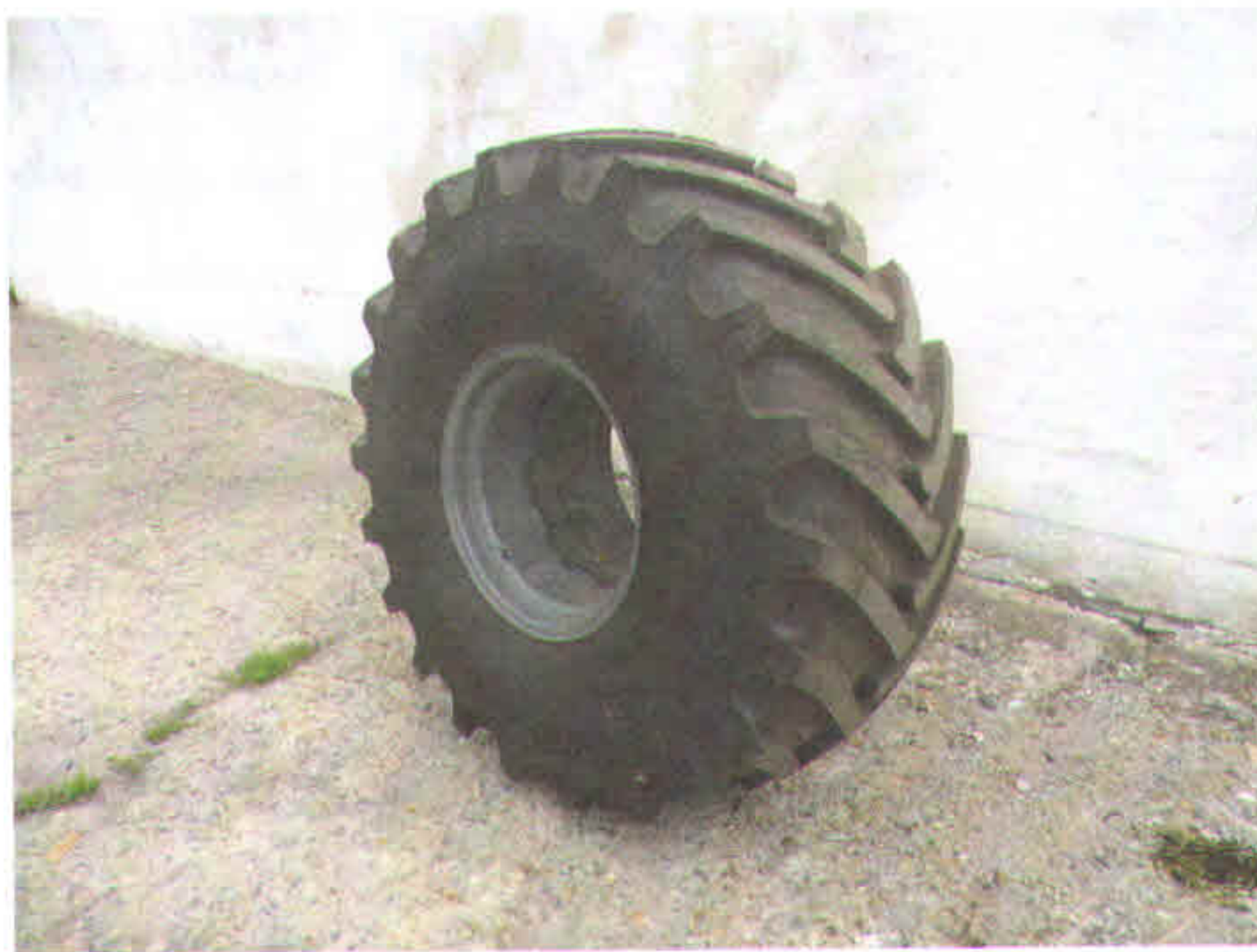
Рисунок 2 - Шина пневматическая 28,1 R26 158 A8 модели ФД-12М, установленная на ободе DW 24×26. Общий вид
